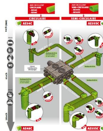
Ils permettent ainsi le raccordement du système de distribution Air Excellent qui se compose de 2 caissons de distribution multidiamètres universels et d'un conduit flexible (circulaire ou semi-circulaire).
