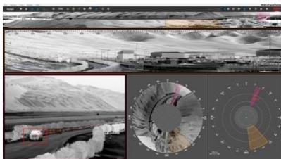
Tout nouveau module de gestion des alarmes, Cyclope 5.0 est capable d'analyser le comportement d'une intrusion détectée. Selon des paramètres déterminés, taille, direction de la menace et tout un tas d'autres paramètres et grâce à la possibilité de fusions avec d'autres données (AIS, ADSB...) l'alerte n'est lancée vers l'hyperviseur que si la menace est confirmée.
