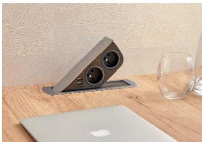
Le bloc prises Cizo affleurant de MSA France offre 2 prises (16 A) et 2 prises USB (2 A) afin d'alimenter appareils électroménagers, smartphones et tablettes. Son clapet s'ouvre de 40° par simple pression, et disparaît en position fermée avec seulement 2 mm d'épaisseur sur le plan. Il peut être installé sur n'importe quel support d'une épaisseur de 5 à 40 mm.
