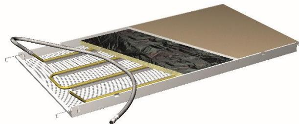
En effet, les nouveaux plafonds chauffants et rafraîchissants de Plafometal sont composés de panneaux acoustiques démontables en métal, activés par la mise en contact de tubes caloporteurs disposés à l'intérieur des bacs. Ceux-ci permettent de répartir de manière homogène la température des panneaux, qui est diffusée par rayonnement aux occupants de la pièce. Ce système est complété par une ventilation naturelle pour favoriser le confort en été.
