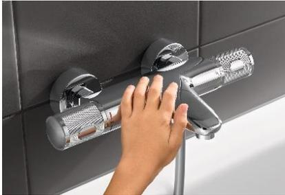
**Équipé de la technologie CoolTouch**, la température du corps du Grohtherm 1000 ne dépasse jamais celle réglée pour l'eau. CoolTouch est un canal de refroidissement innovant, intégré dès l'arrivée d'eau chaude, permettant de créer un cheminement différent de l'eau chaude et de l'eau froide, évitant ainsi les brûlures. Le Grohtherm 1000 est doté d'un bouton **SafeStop**, bloquant la poignée à 38°C, et du **SafeStopPlus** limitant la température maximum à 50°C.
