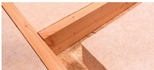
**Flex 55 d'Isonat** : panneau d'isolation flexible à base de **fibres de bois** - 55kg/m<sup>3</sup>, épaisseur 080 mm, dimensions 60x122 cm, R=2,20 m<sup>2</sup>.k/w
