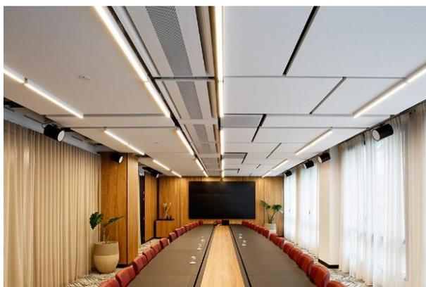
Les panneaux Ecophon Solo Matrix ont été installés dans les salles de réunion, les bureaux, les espaces de réception et l'auditorium. Ces dalles permettent de créer une trame de plafond discontinue qui facilite la division en différents bureaux et offre la possibilité de modifier le cloisonnement au gré des besoins. La disposition des dalles donne une illusion de succession d'îlots flottants, à laquelle s'intègrent parfaitement les installations
