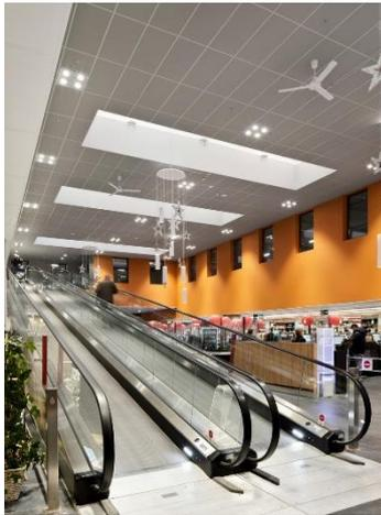
Au-delà de leur atout esthétique indéniable, les dalles de plafond Tonga® Eurocolors de Saint-Gobain Eurocoustic permettent également d'améliorer fortement le confort acoustique à l'intérieur du supermarché. Grâce à un indice d'absorption optimal  $\alpha_w = 1$ , la dalle Tonga® limite considérablement la réverbération des sons et réduit ainsi le bruit ambiant.
