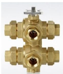
Siemens (division Building Technologies) complète sa gamme de vannes et servomoteurs Acvatix™ avec de nouveaux modèles de vanne 6 voies à boisseau sphérique. Spécialement conçue pour la régulation des plafonds chauffants / rafraichissants 4 tubes, les vannes 6 voies de Siemens remplacent quatre vannes classiques et leur servomoteur.
