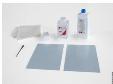
**1.** Se munir du matériel de soudure. Dans le cas d'un matériau filmé, dégager proprement le film protecteur sur la zone à souder. Pour le zinc prePATINA naturel, passer directement à l'étape 4.
